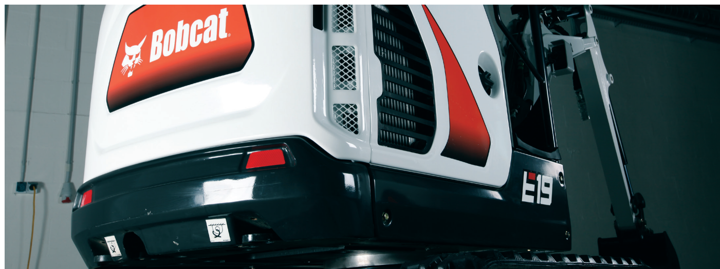
Portellone posteriore protetto da contrappeso ottenuto per fusione
