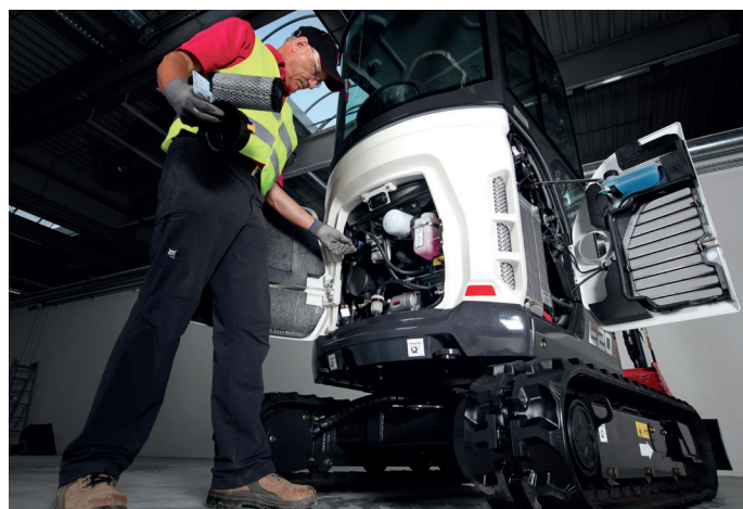
Sostituzione dei filtri
